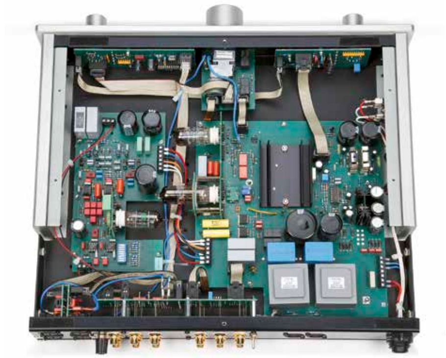
▲ Viel Platz ist da nicht mehr: Die Octave ist mit Bauteilen nicht zu knapp bestückt, eine Röhre arbeitet im Phono-Trakt, die beiden anderen in der Ausgangsstufe. Vor dem XLR-Ausgang sitzen die Übertrager.
